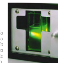
Se realiza la medición en una cubeta de vidrio de 25 ml y dura aproximadamente 1 minuto.
