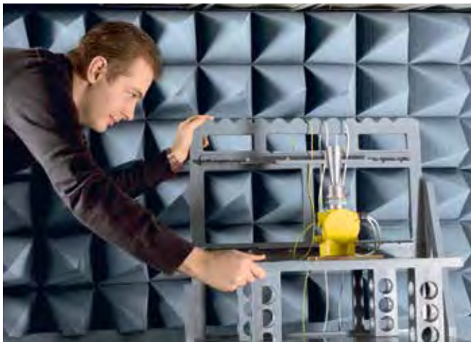
Garantía de una calidad sin problemas: la celda de medición GTEM (Gigahertz Transverse Electromagnetic Cell)
