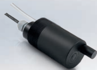
OPTISENS TUR 2000 Sensor de luz dispersa de 90° para medir la turbidez provisto de NIR-LED para estabilidad a largo plazo y limpieza automática
