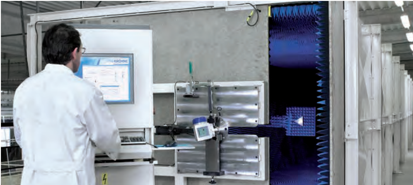
Túnel de calibración para medidores de nivel FMCW
