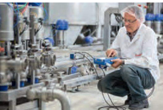
Medida de caudal temporal con caudalímetro clamp-on en una central lechera
