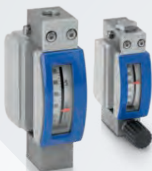
DK32/34 Para caudales bajos de líquidos o gases, indicador mecánico compacto, interruptores MÍN./MÁX. opcionales y válvula de aguja
