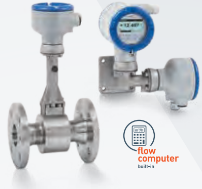
OPTISWIRL 4200 F Versión remota con convertidor de alojamiento de campo con cable de conexión de hasta 50 m/164 pies
